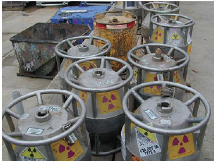
Фигура 18. Контейнери за транспорт и съхранение на неутронни източници, използвани при сондиране на нефтени кладенци
