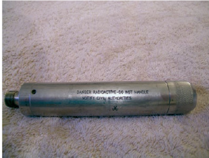
Фигура 15. Неутронен източник с ^{241}\text{Am}/\text{Be} за каротаж на нефтен кладенец
