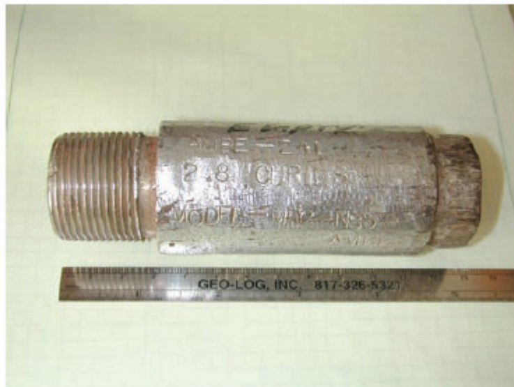
Фигура 16. Неутронен източник с ^{241}\text{Am}/\text{Be} за каротаж на нефтен кладенец - повреден в следствие на постоянна употреба
