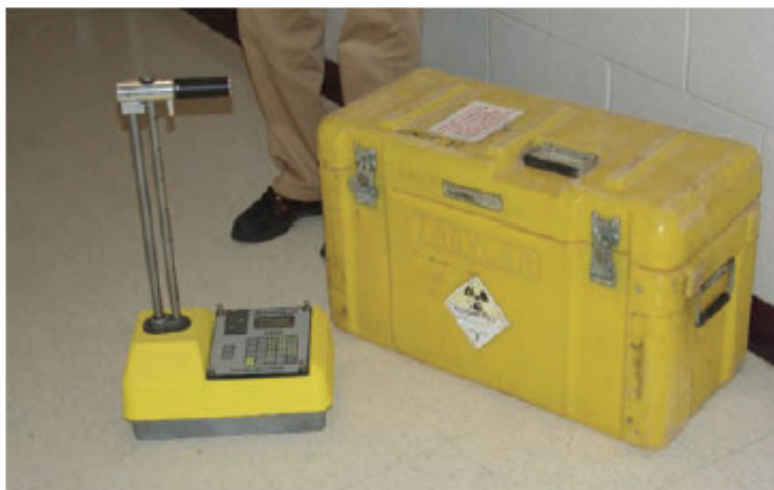
Фигура 22. Уред за измерване на влага и плътност на почви и куфар за неговото транспортиране (Troxler)
