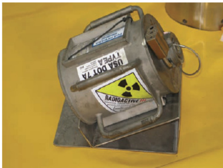
Фигура 14. Транспортен контейнер на уред за каротаж на нефтен кладенец с Cs 137 източник
